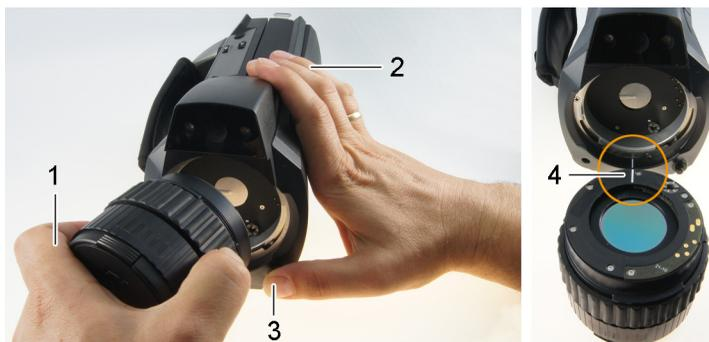
1. Maintenir l'objectif de la main gauche (1) et la caméra de la main droite (2), puis appuyer sur le **[déverrouillage de l'objectif]**.
