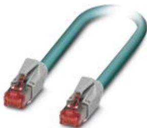
Câble Ethernet préconfectionné, blindé, à 4 paires, AWG 26 souple (7 fils), RAL 5021 (bleu d'eau), connecteur mâle RJ45/IP20 sur connecteur mâle RJ45/IP20, longueur 5 m
