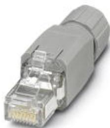
Connecteur mâle RJ45, IP20, CAT5e, 4 pôles, PROFINET à raccordement autodénuant QUICKON, pour conducteurs de 1 à 7 fils AWG 22, pour diamètre de câble 4,5 mm ... 8,0 mm, coloris : gris
