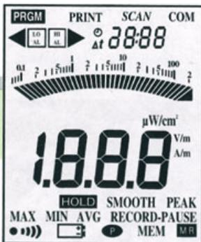
L'afficheur 2000 points (50 x 60 mm) offre un confort de lecture maximal. Véritable tableau de bord, il rappelle en permanence toutes les fonctions en service.
