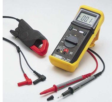
Le lot C.A 5205G + minipince MN 89 : mesure de 0,5 A à 240 A - en toute simplicité et sécurité. Rapport sortie/entrée de la minipince : 100 mV ∓ / 1 A ∓.
