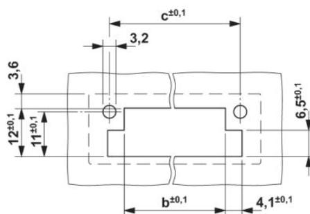
Cote b = 3,02mm + (nbre de pôle x 5,08mm)
