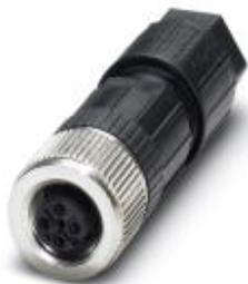
Connecteur, 5-pôles, Connecteur femelle droite M12, détrompage A, Raccordement à ressort, Matériau de la molette: Zinc moulé sous pression, nickelé, Diamètre extérieur du câble 4 mm ... 8 mm
