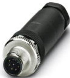
Connecteur, 8-pôles, Connecteur droite M12, détrompage A, Raccordement vissé, Matériau de la molette: Zinc moulé sous pression, nickelé, Presse-étoupe Pg9, Diamètre extérieur du câble 6 mm ... 8 mm
