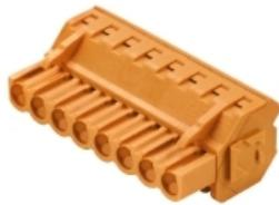
Connexion à étrier pour raccordement de fil à la perpendiculaire (90°/270°) ou coudé (225°). Les connecteurs femelle disposent d'espace pour les marquages et peuvent être codés. Fixation par bride ou par levier de verrouillage. Ils disposent également d'une vis plus/moins intégrée et d'une protection contre toute mauvaise insertion du connecteur. Ils sont livrés avec étriers ouverts. HC = Courant fort.
