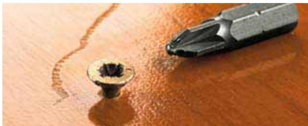
Les embouts courants glissent ou sortent rapidement de la vis et endommagent souvent la tête de vis ainsi que les surfaces précieuses des matériaux.
