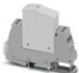
Parafoudre basse tension de type 2/3 composé d'une fiche de protection et d'un élément de base pour indicateur d'état intégré et signalisation à distance pour les réseaux d'alimentation monophasés. Tension nominale : 230 V AC/DC.
