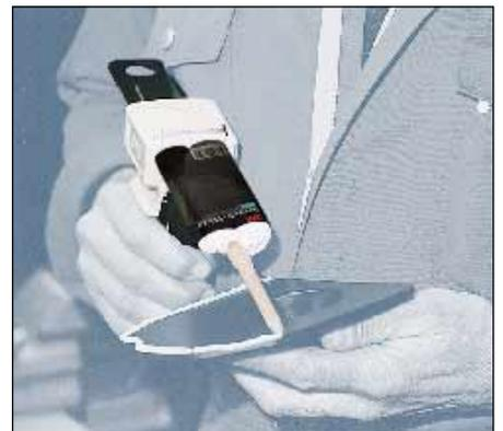
Assemblage de pièces automobiles intérieures (PU)
