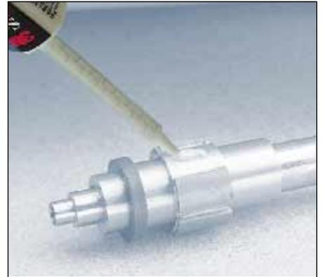
Fixation d'un aimant sur un rotor en acier
