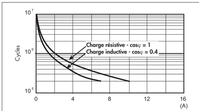
F 55 - Durée de vie électrique (AC) en fonction de la charge
