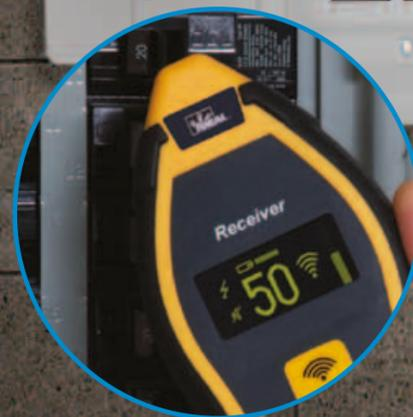
En mode fusible, le récepteur identifie le circuit correct sur lequel l'émetteur est connecté.
