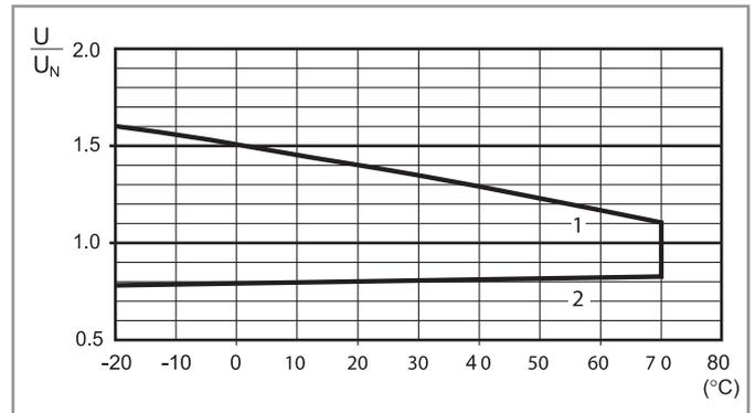
R 62 - Plage de fonctionnement bobine DC en fonction de la température ambiante - Type NO
