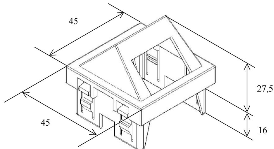
La forme inclinée du plastron offre une mise en place du connecteur et du Câble de meilleur qualité car toute courbure importante du câble fragilise celui ci et diminue ces performances à hautes fréquences. L'inclinaison du plastron offre un rayon de courbure élevée au câble qui, sans contrainte, offre des performances optimale dans les passages de câble de faibles profondeurs.
