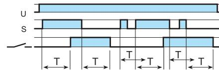
**(CE) Temporisé à la mise sous tension et à la coupure avec signal de commande.**
