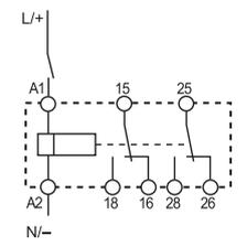
Schéma de raccordement (sans signal de commande)
