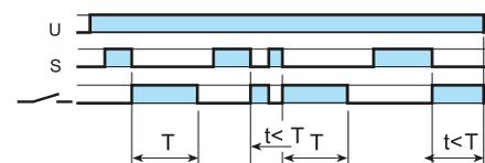
**(EE a) Intervalle au retrait du signal de commande.**
