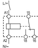
Schéma de raccordement (sans signal de commande)
