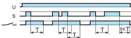
**(BE) Temporisé à la coupure avec signal de commande.**
