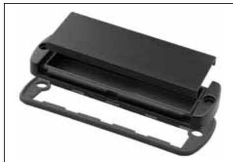
**ABM...AL** – Le couvercle de montage dispose d'une surface de montage en retrait pour la mise en oeuvre de connecteurs et douilles divers. Pour obtenir une protection IP 65 de l'espace de montage on enclipse un capot en aluminium équipé d'un joint.
