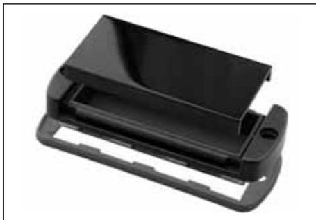
**ABM...IR** – Le couvercle de montage dispose d'une surface de montage en retrait pour la mise en oeuvre de connecteurs et douilles divers. Pour obtenir une protection IP 65 de l'espace de montage on enclipse un cache en plastique IR translucide.
