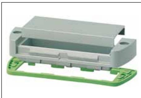
**ASM...AL** – Le couvercle de montage dispose d'une surface de montage en retrait pour la mise en oeuvre de connecteurs et douilles divers. Pour obtenir une protection IP 65 de l'espace de montage on enclipse un capot en aluminium équipé d'un joint.
