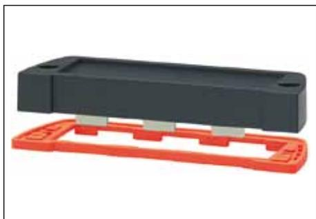
**ASD** – Le couvercle d'extrémité est doté d'une surface en retrait de 2 mm pour la mise en place de claviers membranes. Tous les couvercles possèdent des surfaces de contact qui mettent le couvercle en contact avec le profilé. Ainsi un boîtier standard garantit déjà une bonne protection CEM. Pour obtenir une plus grande résistance CEM des joints CEM noirs en matériau avec inclusion de métal sont à votre disposition.
