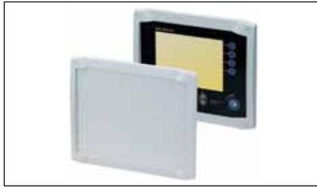
**CF:** Cette face de montage offre une surface en retrait pour le montage de claviers membranes et peut être vissée de façon optimale par quatre vis à une face arrière. Le joint disponible en option permet d'atteindre le type de protection IP 65 par rapport à la paroi de montage. Non combinable avec les parties inférieures Bocard.
