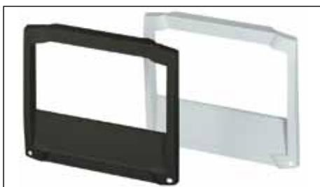
**FO-K:** Le cadre FO-K couvre une face avant (FP...K) et un compartiment de connexion. Le couvercle intégré du compartiment de connexion dispose d'une surface en retrait de 1,5 mm pour la mise en place de claviers membranes. Le cadre est placé sur la partie inférieure, fixé par pression à 2 endroits et vissé sur le compartiment de connexion. En combinaison avec partie inférieure et face avant : type de protection IP 40.
