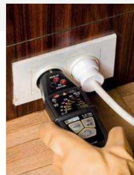
L'adaptateur C.A. 753, par sa conception, permet l'usage de toutes pointes de mesure ( $\emptyset 2$ ,  $\emptyset 4$ , IP2X, ...). Il évite tout risque de non-détection de tension en garantissant un bon contact électrique et mécanique entre celles-ci et la prise 2P+T.
