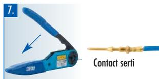
Sertir ensuite en refermant à fond les deux branches de la pince jusqu'à sa réouverture. Vérifier visuellement que le contact est correctement serti: le fil doit être visible par le trou d'évent et l'isolant du fil doit être appliqué contre l'arrière du contact.
