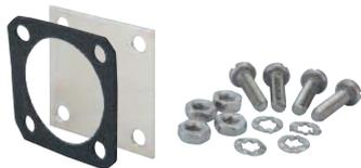
Ce kit d'obturation est destiné à boucher le trou dans la paroi effectué pour la fixation de l'embase lorsque celle-ci n'a plus son utilité. Après avoir retiré l'embase, placer le joint puis la plaque d'obturation. Visser ensuite le tout à l'aide des 4 vis, écrous et rondelles.
