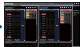
Les éléments affichés dans chaque fenêtre peuvent être spécifiés par le châssis, le module ou les voies. (ex. : les signaux mesurés dans chaque appareil sont affichés dans des écrans séparés.)
