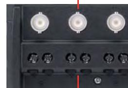
Vis M3 pour une mesure de température
