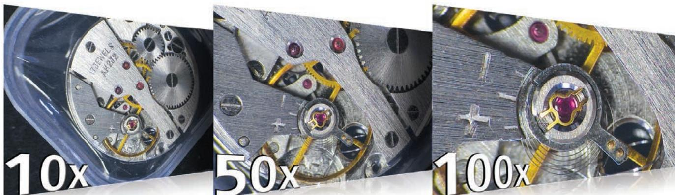
Le système Makrolite II permet de visualiser des échantillons dans leur intégralité grâce à son très grand champ de vision. Il suffit de zoomer sans changer la mise au point pour procéder à une inspection dans les moindres détails. Grossissement de x10 à x100 avec la lentille DCR250
