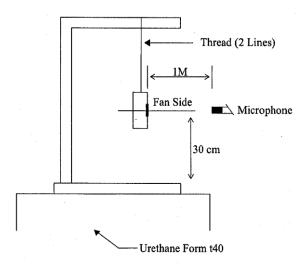
1 METER FROM MICROPHONE TO FAN INTAKE
