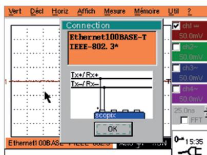
SCOPIX BUS propose une aide à la connexion fonction du bus à vérifier avec le schéma de câblage correspondant.
