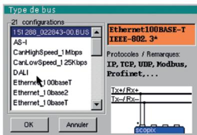
14 bus, 21 configurations disponibles, plusieurs protocoles (IP, TCP, Modbus, Profinet...) déjà intégrés dans le SCOPIX BUS, sélectionnables dans un menu déroulant.
