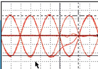
**Diagramme de l'œil**, un plus pour la visualisation récurrente des données : cumul des traces à l'écran avec alternance de la polarité des fronts de déclenchement.
