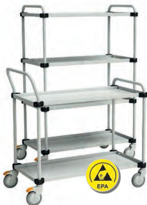
Chariot pour atelier, bureau, zones de production, hôpitaux. Tablettes en acier émaillé RAL 7035 antistatique, profondeur 28 mm. Toutes les tablettes sont réglables individuellement. Structure légère mais robuste. Les cadres latéraux de la desserte sont réalisés en tube acier émaillé (25 mm). Quatre roulettes pivotantes (Ø 125 mm), dont deux avec frein.
