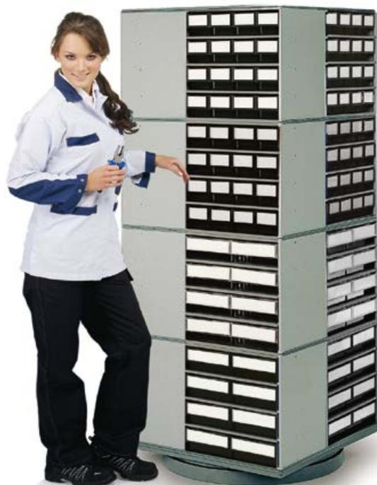
Système de rangement rotatif autonome pour l'industrie de l'électronique. La base résistante montée sur roulement à billes possède une capacité de charge de 800 kg. Cette configuration offre un espace de rangement pouvant accueillir jusqu'à 1792 éléments différents sur une surface au sol de 0,64 m<sup>2</sup> seulement. L'unité comprend une base sur roulement à billes et des étagères sur 4 niveaux. Mise à la terre par résistance de protection 1 mégohm. Assemblage aisé - aucun outillage requis.
